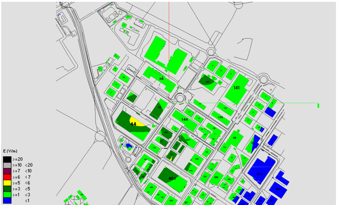
Fig. 38 Impatto Elettromagnetico – zona Zona Industriale Gello – Vista dall'alto senza solido
