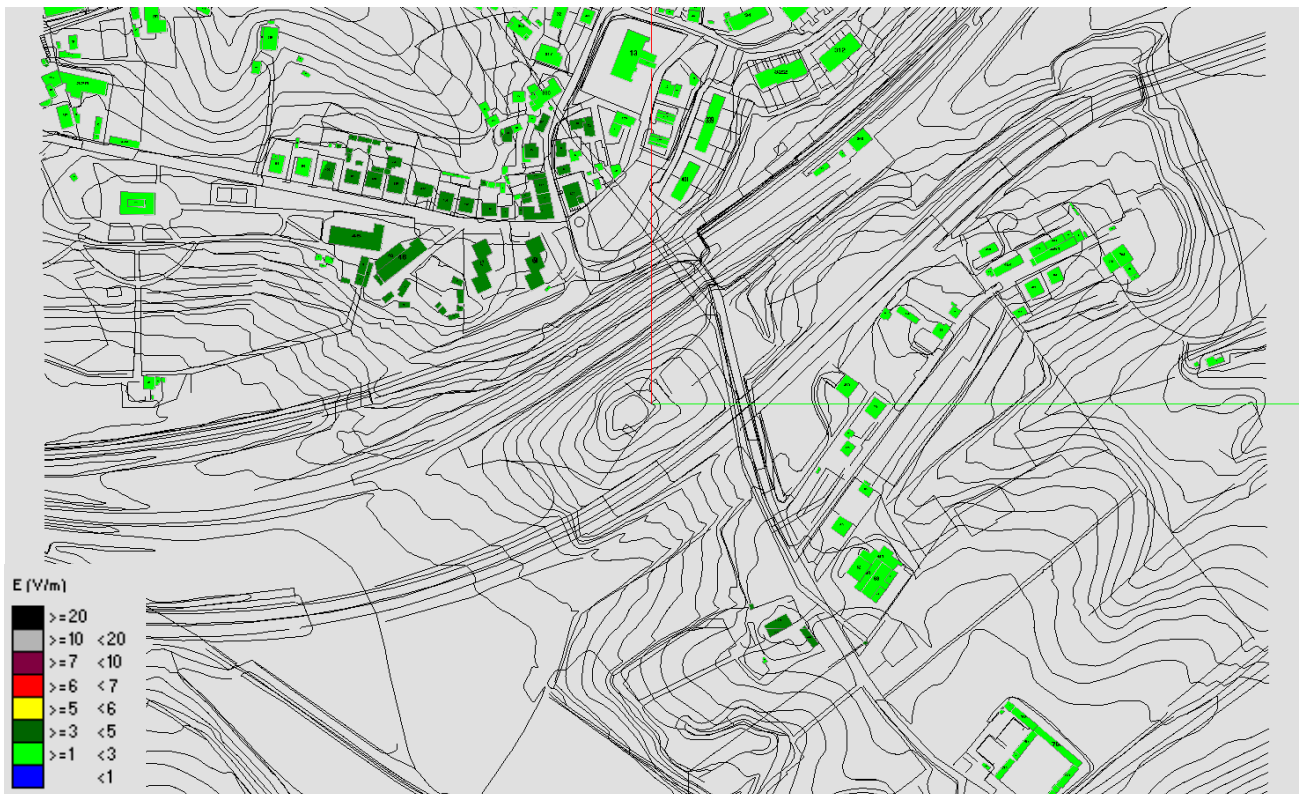
Fig. 43 Impatto Elettromagnetico – zona Loc. La Rotta Ipotesi 1 – Vista dall'alto senza solido
