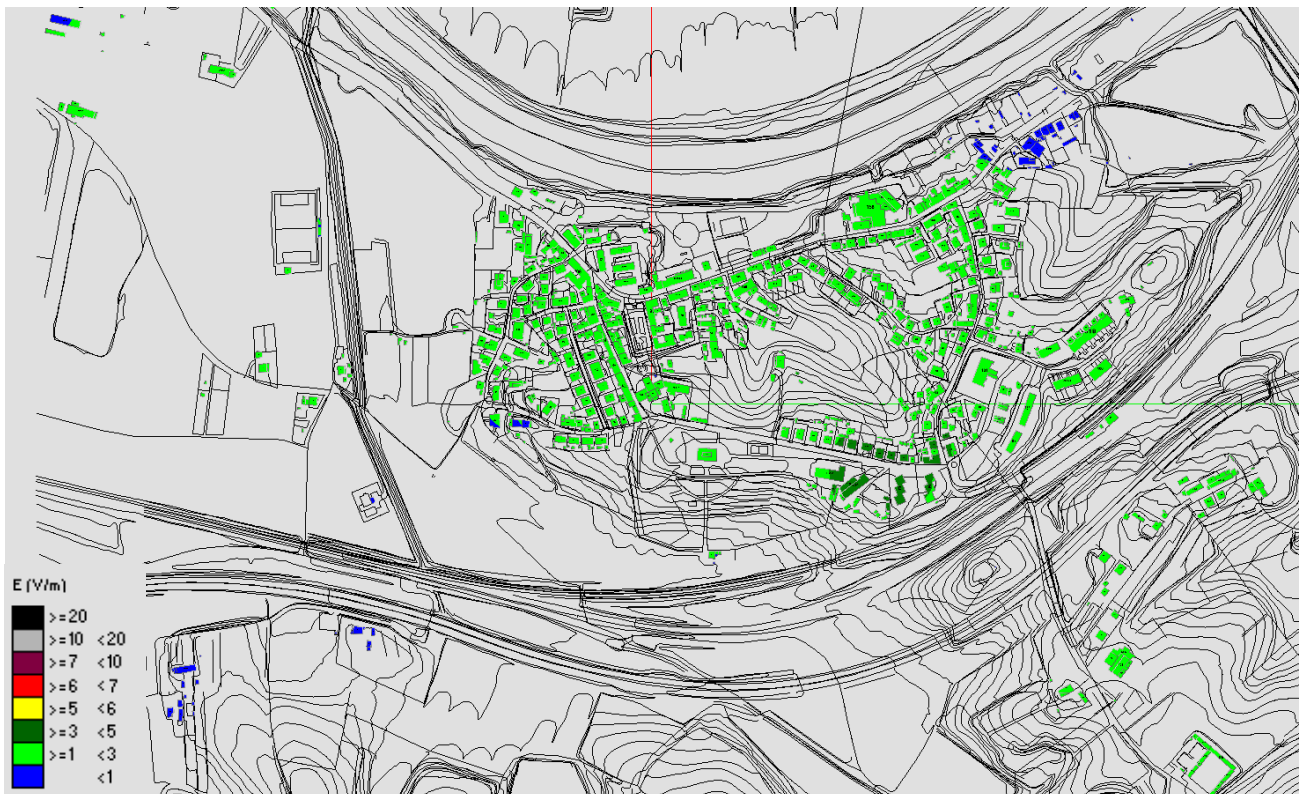
Fig. 48 Impatto Elettromagnetico – zona Loc. La Rotta Ipotesi 2 – Vista dall'alto senza solido
