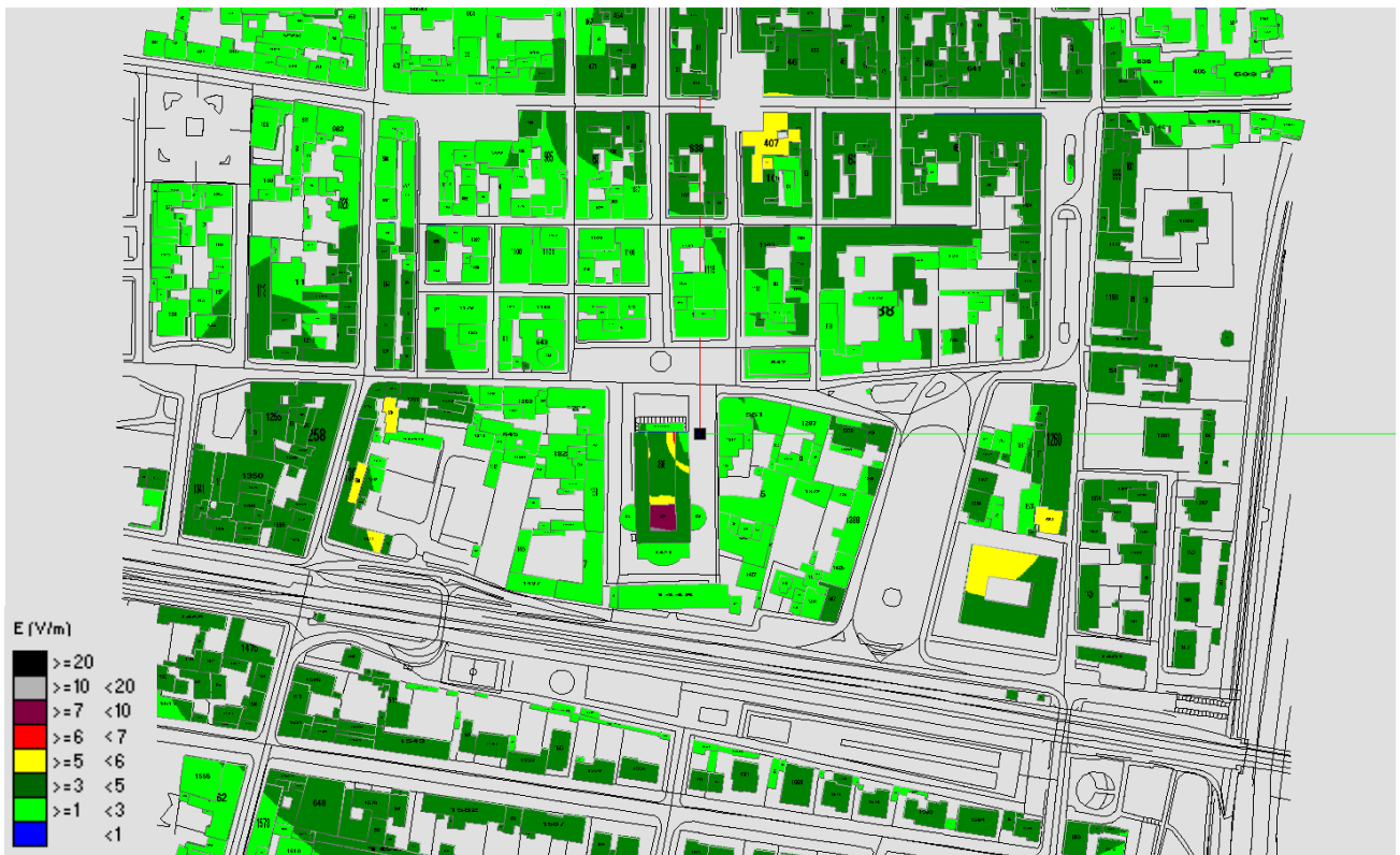
Fig. 8 Impatto Elettromagnetico – zona Piazza Caduti c/o Torre Duomo – Vista dall'alto senza solido
