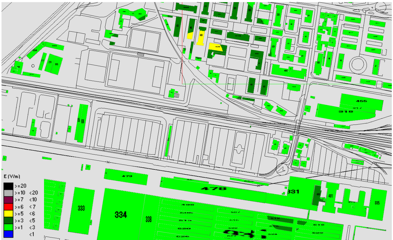
Fig. 3 Impatto Elettromagnetico – zona Via Peppino Impastato – Vista dall'alto senza solido
