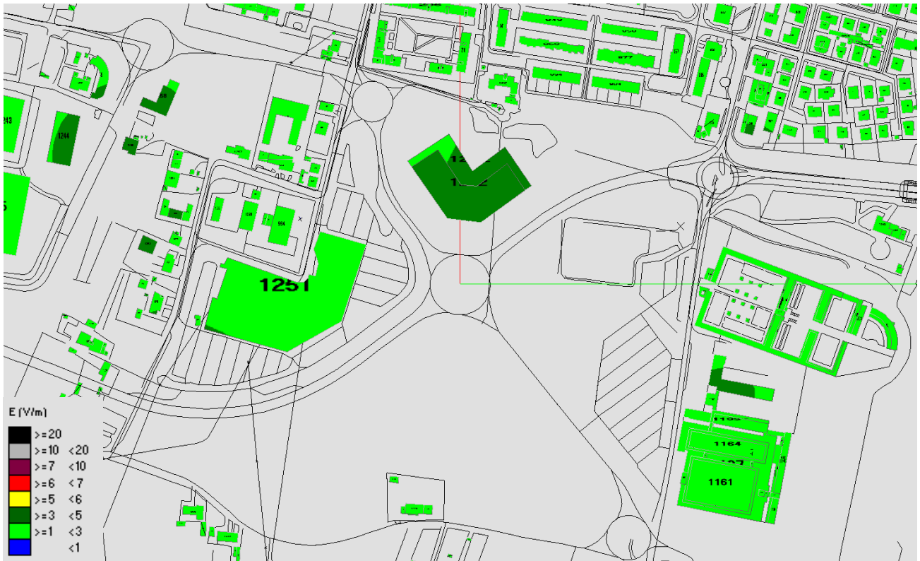
Fig. 33 Impatto Elettromagnetico – zona Via Nicolaioni – Vista dall'alto senza solido
